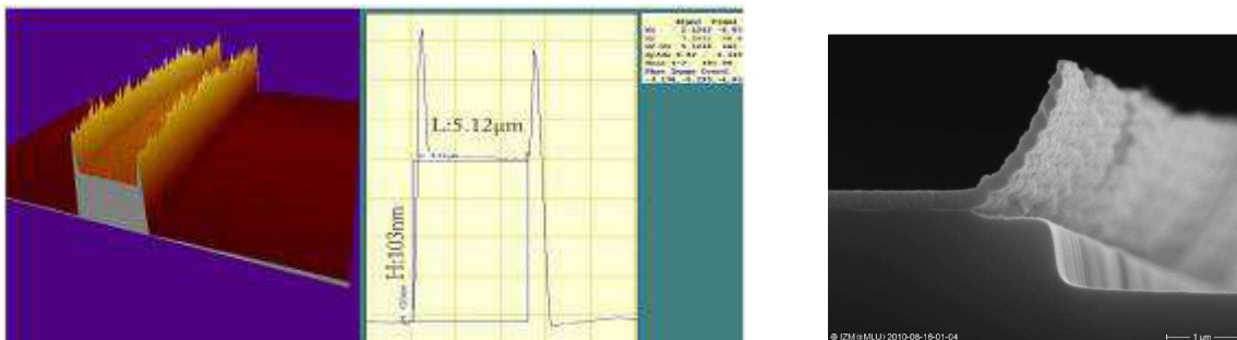
Abb. II.6: Links: Querschnittsmessung eines Bolometerstreifens mittels Atomkraftmikroskopie (AFM). Bei diesen Streifen ist der Rand erhöht, da im Lift-Off-Prozess ein unzureichender Unterschnitt nach der Lackentwicklung an den Strukturrändern vorlag. Rechts: SEM-Aufnahme eines fehlgeschlagener Lift-off-Prozesses. Die Abstehende Struktur lag zuvor auf der schrägen Randfläche des Photolacks.
