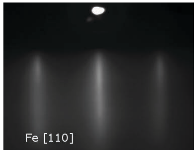
Abb. 1: RHEED Messung an 0.6 nm Fe entlang der [110] Richtung.
